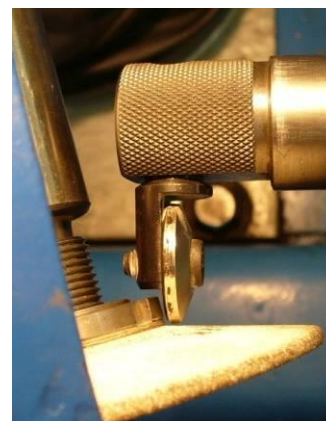
Obrázok č.4.4 orovnávanie zadnej vypuklej časti kotúča
