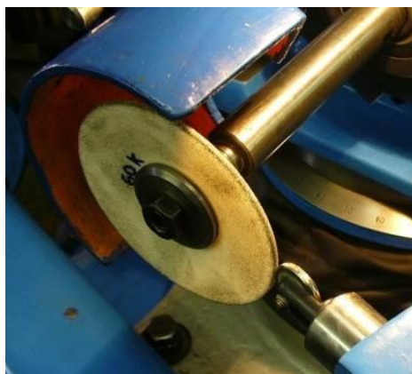
Obrázok č.4.3 Uchytenie kotúča - čap, prírubá a orovnávanie obvodu []
