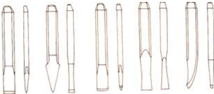
Obrázok č. 3 Základné druhy sekáčov /plochý, krížový, so zakriveným ostrím, deliaci, na drážky/
