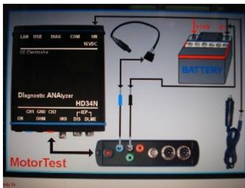
Obrázok 28 Zapojenie analyzátora pre test lambda sondy (foto autor)
