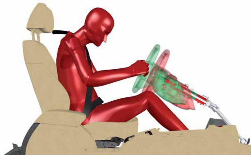
Obrázok 7 Systém bezpečnostného stĺpika riadenia (Škoda, Dielenská učebná pomôcka, 12/2009 str. 30)
