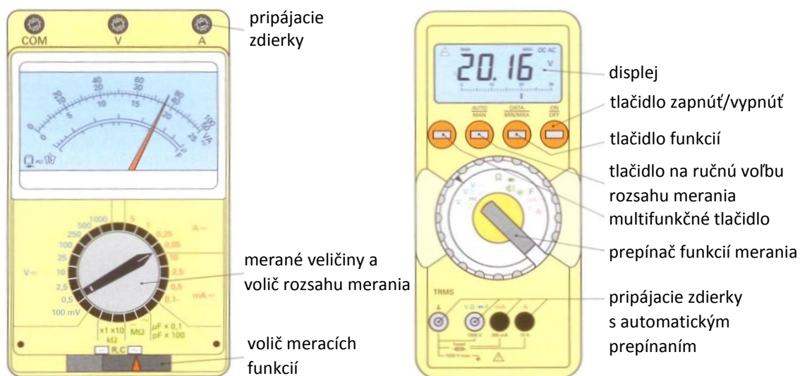
Obr. 1 Analógový univerzálny merací prístroj Obr. 2 Digitálny univerzálny merací prístroj
