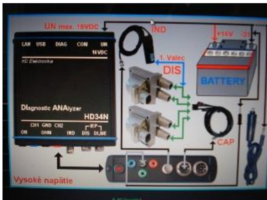
Obrázok 68 Zapojenie analyzátora pre test sekundárneho napätia zapalovania, (foto autor)
