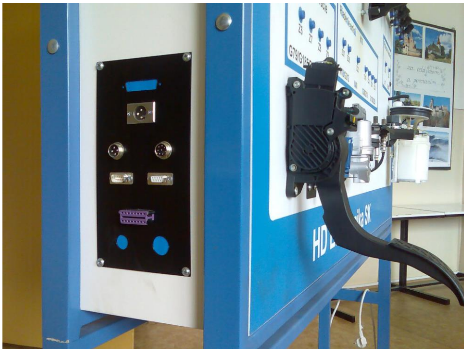
Obrázok 59 Zásuvka sériovej diagnostiky výukového panelu(fialová) (foto, autor)
