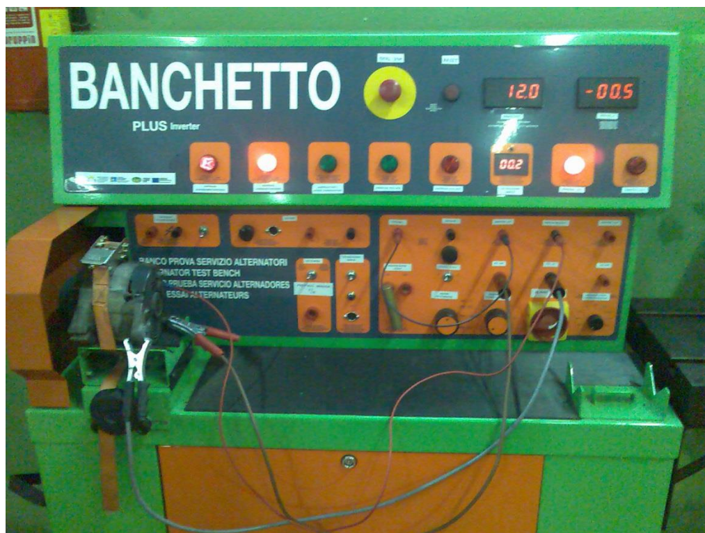
Obrázok 12 Zapojenie alternátora na skúšobnej stolici (foto autor)
