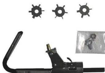
Obr. 144 Náradie používané pri montáži piestnych krúžkov
