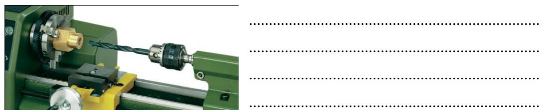
Obrázok č.2 Upnutie nástroja na sústrahu
