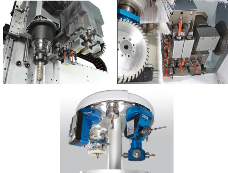
Obrázok 34 Príklady obrábacích agregátov v pohotovostnej polohe a v zásobníku nástrojov
