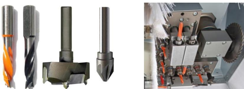
Obrázok 40 Príklady vŕtacích nástrojov a vŕtacieho agregátu
