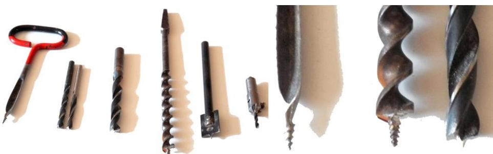
Obrázok 12: Typy vrtákov a vŕtacích hrotov do ručných vrtačiek
