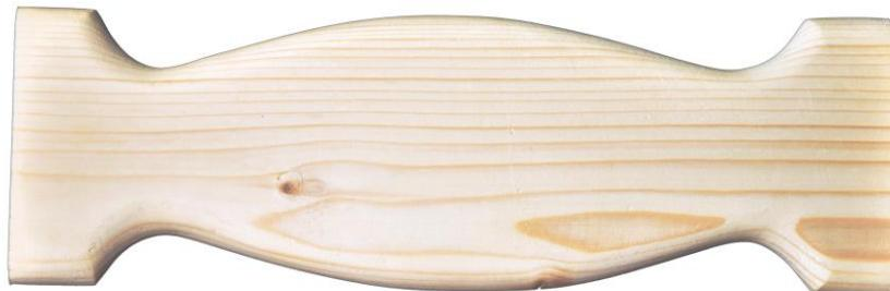
Obrázok16: Tvarovanie bočných plôch do polkruhového profilu
