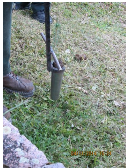
Obr. 31 Zápich sadzača do zeme, otočenie o 180 stupňov, vysunutie sadzača s mačinou (foto: V. Dudíková)
