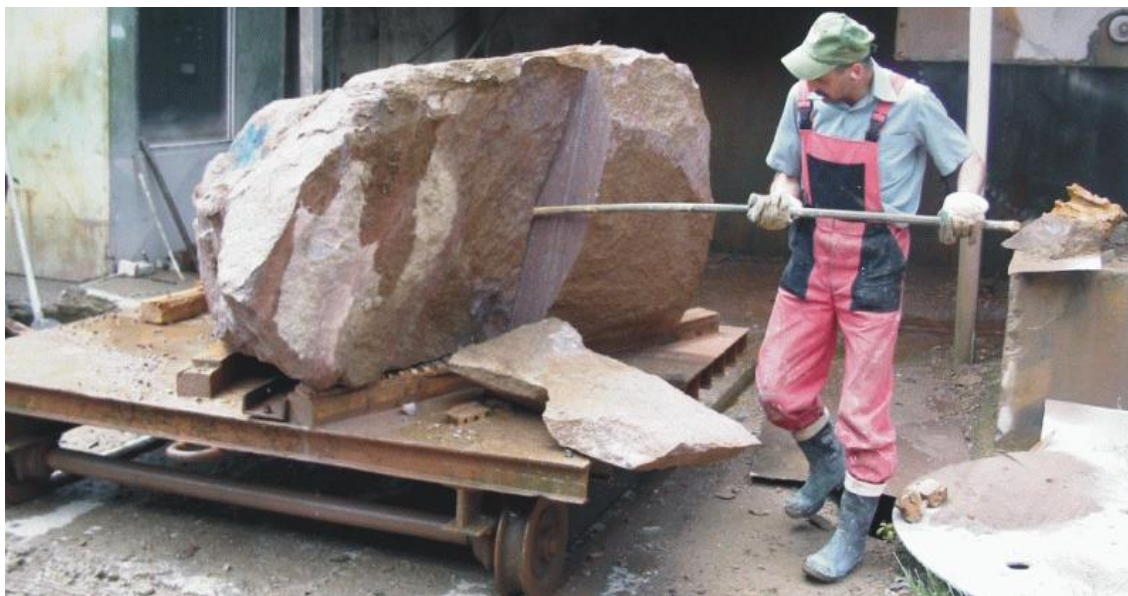
Obrázok. 36 Ručné sekание kameňa
