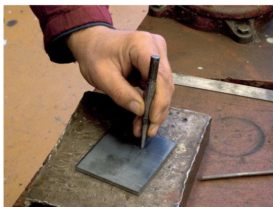
Obrázok 47 Náradie na označenie otvorov
