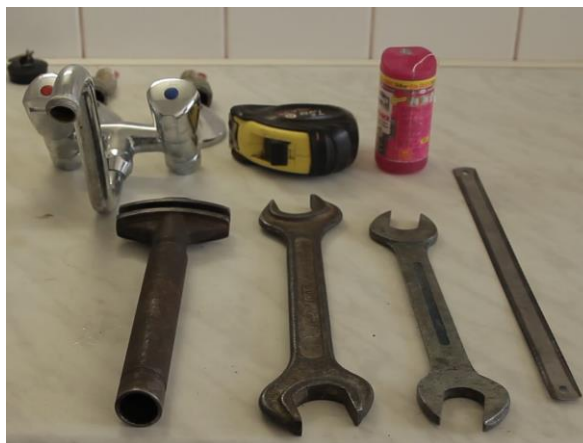
Obr.č.48 - Náradie potrebné k montáži nástennej výtokovej armatúry
