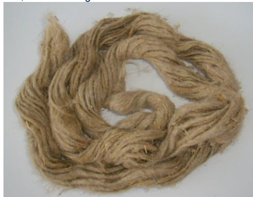
Obr.č.9 (a, b) – Tesniaci materiál na utesnenie liatinového hrdlového spoja
