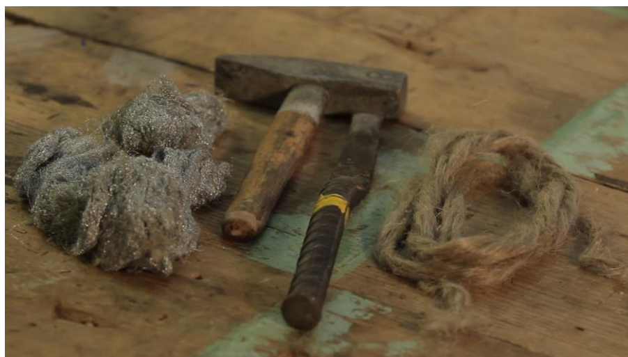
Obr.č.10 – Materiál a náradie potrebné na vytvorenie spoja liatinového potrubia
