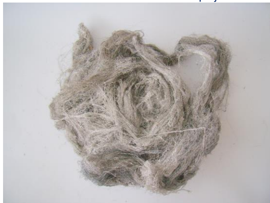
Obr.č.9 (a, b) – Tesniaci materiál na utesnenie liatinového hrdlového spoja
