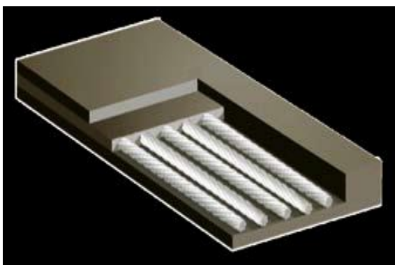
Obr.63 Konštrukcia oceľolánového DP
