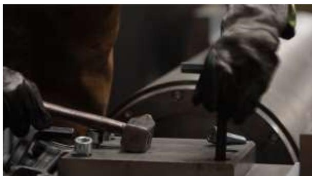
Obrázok 46 - Demontáž ložiskových telies
