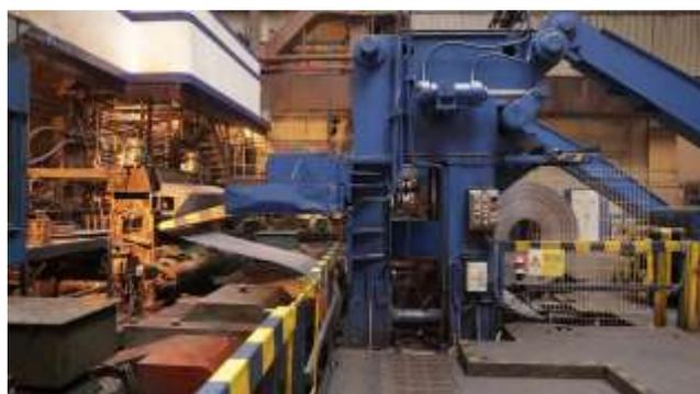
Obrázok 42 - Zavádzanie pásu do 4-stolicového tandemu
