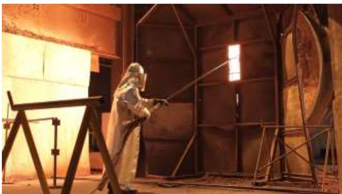
Obrázok 40 - Prepaľovanie výtokového uzla LP
